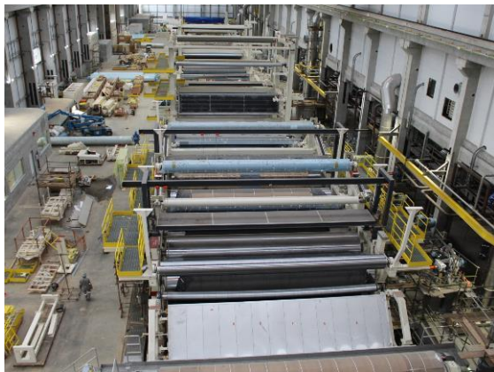
Maior máquina de papel do mundo Projeto PUMA II – Klabin Ortigueira, PR (11.786 toneladas montadas)
